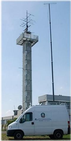
Gli strumenti utilizzati per la ricerca delle interferenze sono la torretta di controllo e il furgone con l'antenna telescopica da 11m. La torretta di controllo possiede una dozzina di antenne con ricevitori diversi per tenere sotto controllo tutte le frequenze. Nel furgone, il ricevitore dell'antenna è posizionato a 45° in modo da raccogliere i segnali polarizzati verticalmente e orizzontalmente.
