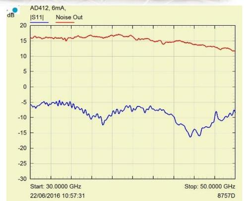
I generatori costruiti verranno utilizzati per la taratura dei 19 elementi del ricevitore 33-50GHz che sarà installato in Sardegna. Il segnale ricevuto dallo spazio è essenzialmente rumore senza una scala di riferimento. Gli strumenti costruiti funzionano come unità generatrici di rumore a valore noto. Il ricevitore li utilizza come riferimento per dare un valore esatto al segnale ricevuto dallo spazio.
